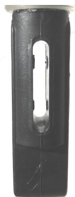
Рис. 1.4. Датчик. В полости датчика видны четыре электрода
