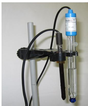
Рис. 2.12. Комбинированный электрод и датчик температуры
