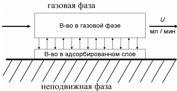
Рис. 6.12. Вещество в газовой фазе и вещество в адсорбированном слое находятся в равновесии и передвигаются по колонке как единая зона или фракция.  $U$  – объёмная скорость газа-носителя
