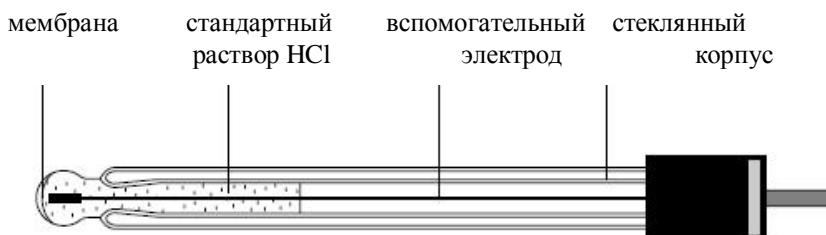
Рис. 2.4. Устройство стеклянного электрода
