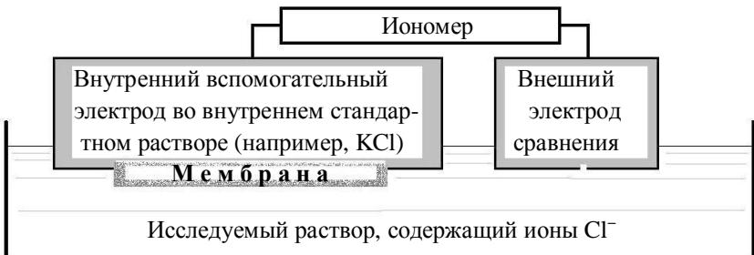
Рис. 2.9. Схема измерительной ячейки с ионоселективным электродом для определения хлорид-ионов
