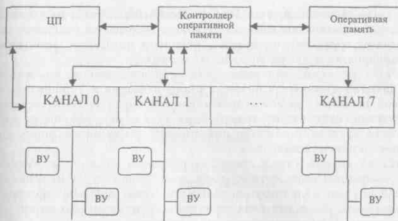
Рис. 5.4. Упрощенная схема ЭВМ с каналной организацией. ЦП — центральный процессор; ВУ — внешние устройства
