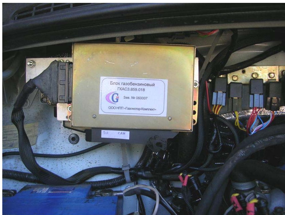
Рис. 9. Расположение МПСУ в подкапотном пространстве а/м «Соболь»
