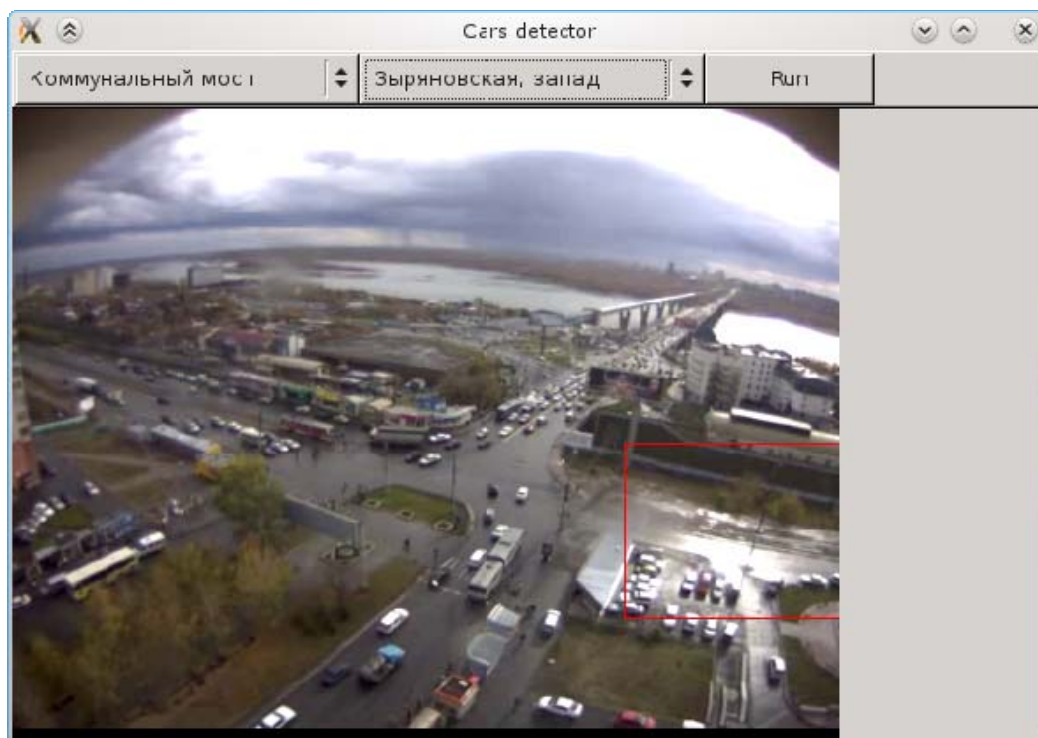
Рис. 3. Настройка местоположения улиц на экране
