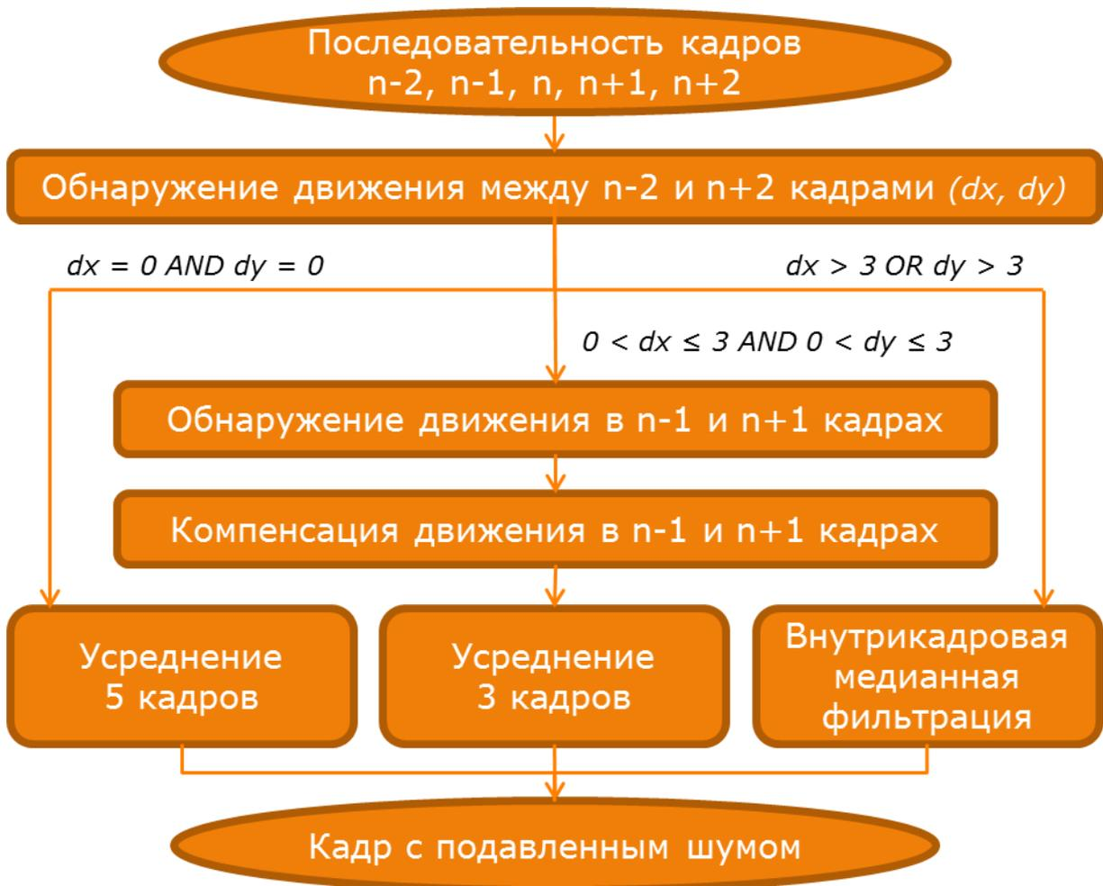
Рисунок 4.1. Блок-схема модифицированного алгоритма.
