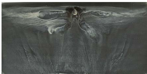
Рис. 9. Присоединенное течение после установки одного конического выступа. Срыв потока удалось устранить. По обеим сторонам от выступа образовался отрывной пузырь со сложным вихревым течением внутри него
