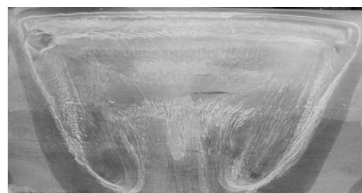
Рис. 12. Повышенная турбулентность, выступа нет. На крыле наблюдаются срыв потока и образование пары вихрей в зоне возвратного течения
