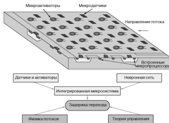
Рис. 11. Схема активного контроля процесса перехода к турбулентности с использованием микроскопических электромеханических систем
